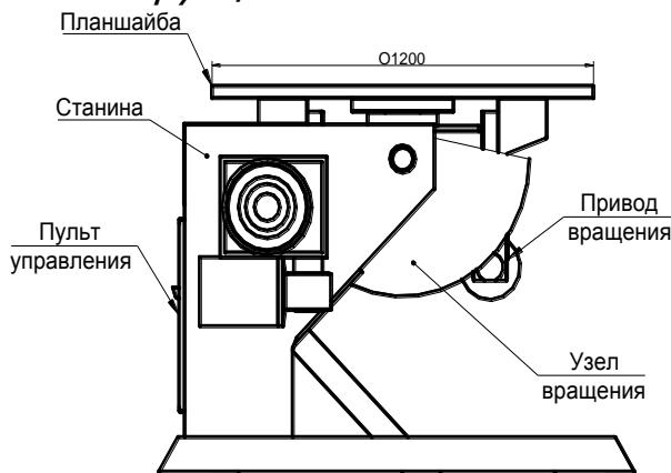
Кинематическая схема вращателя состоит из двух самостоятельных механизмов: привода вращения и привода наклона стола с планшайбой.
