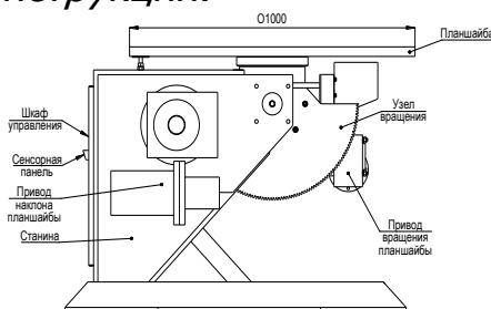
Кинематическая схема вращателя состоит из двух самостоятельных механизмов: привода вращения и привода наклона стола с планшайбой.
