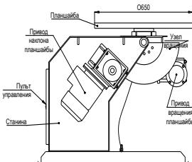
Кинематическая схема вращателя состоит из двух самостоятельных механизмов: привода вращения и привода наклона стола с планшайбой.
