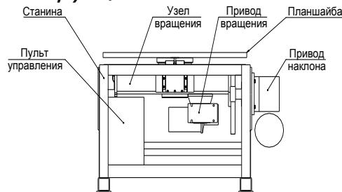
Кинематическая схема вращателя состоит из двух самостоятельных механизмов: привода вращения и привода наклона стола с планшайбой.
