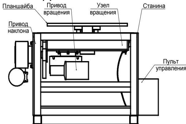
Кинематическая схема вращателя состоит из двух самостоятельных механизмов: привода вращения и привода наклона стола с планшайбой.
